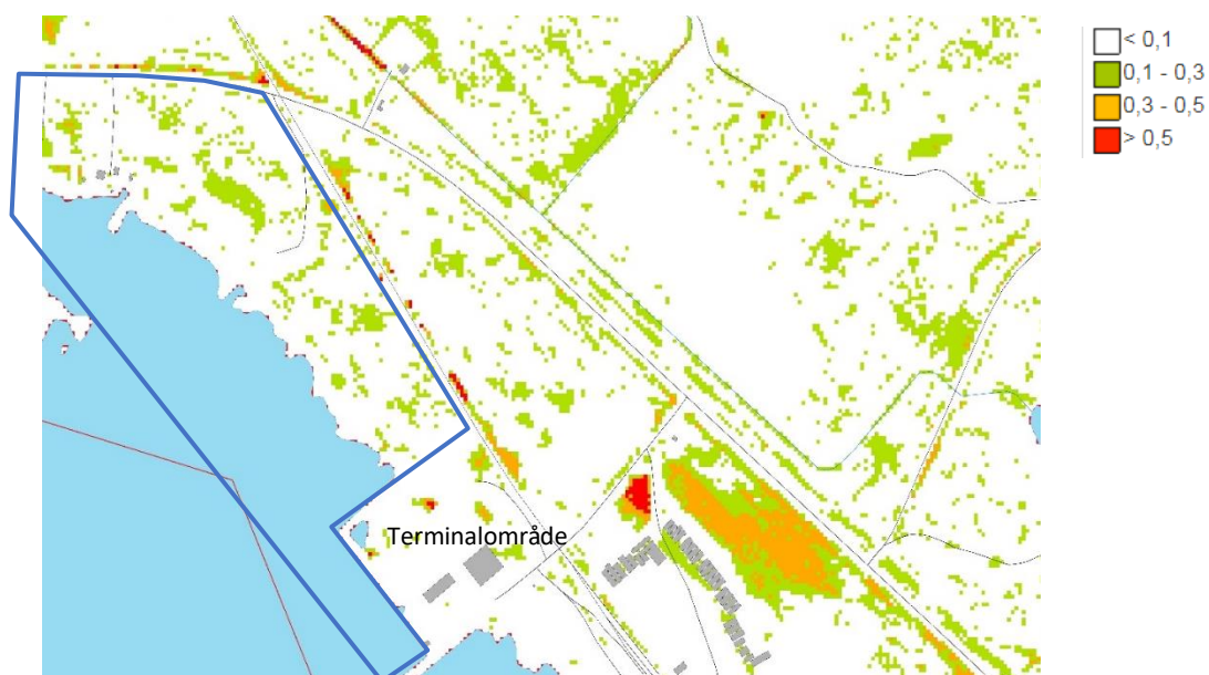
Figur 15. Utdrag ur Översvämningsmodellering Piteå, DHI, 2015. Figuren visar översvämning vid framtida 100-årsregn där planområdet är inritad med blått.
